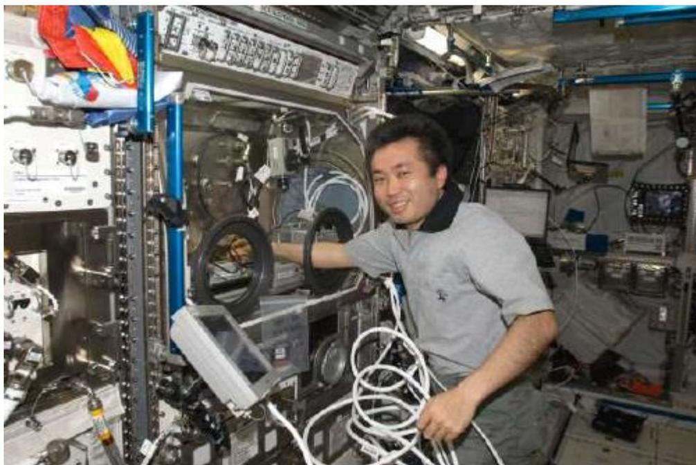
図 21 マイクログラビティグローブボックス (MSG)
