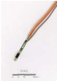
研究室で使われる血管内ブラッキーセラピー治療用線量計の試作品
